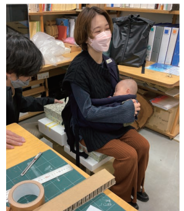
原寸大模型を用いたソファベンチのデザイン検討
